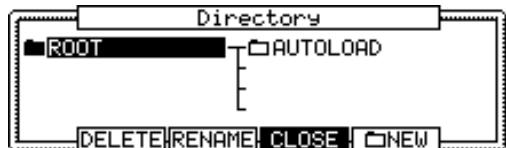
Directoryウィンドウが表示されます。Directoryウィンドウではメモリーカードの内容を見る事ができます。メモリーカード内のファイルは、一般的なコンピューターのファイルと同じように階層で管理されています。
