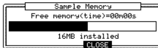
Free memoryフィールドには、今空いているメモリーであとどれくらい録音できるかが時間表示されます。その下にはメモリーの状態がバーグラフで表示されます。バーグラフの下には、MPC1000本体に搭載されているRAMの総容量が表示されます。
